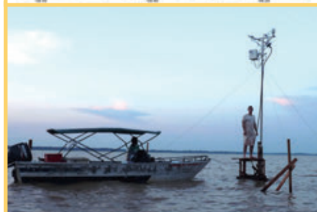
En haut, localisation du site d'étude En bas, installation de la station d' « eddy covariance »
