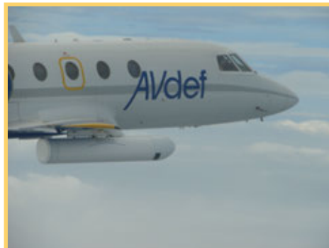
Pod contenant le radar SETHI de l'ONERA embarqué sous un Falcon de la société Avdef.
