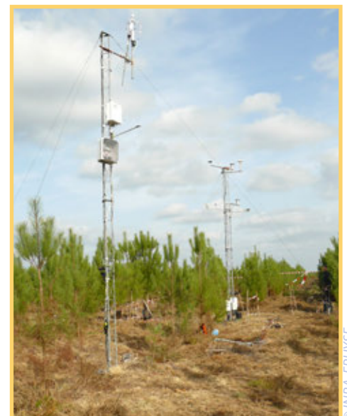
Mesures de flux de CO 2 /H 2 O par la méthode des corrélations turbulentes et micrométéorologie sur le nouveau site de la forêt de Bilos, commune de Salles, novembre 2009
