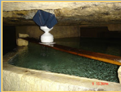
Observation et suivi du débit d'eau, du CO 2 et de la géochimie de l'eau d'un karst actif dans une cavité souterraine à Saint-Emilion
