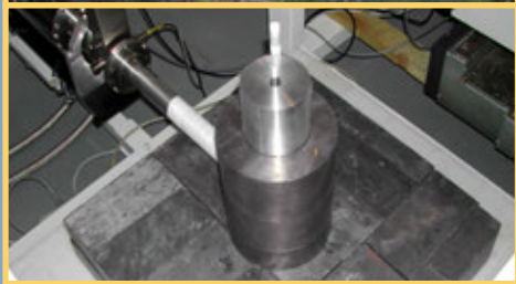
En haut : Le nouveau bâtiment de PRISNA à Gradignan. En bas : Spectromètre \gamma de type puits. L'échantillon est placé dans un tube (hauteur : 6 cm) afin de mesurer les émetteurs gamma ( ^{210}\text{Pb} , ^{234}\text{Th} , ^{226/226/224/223}\text{Ra} , ^{137}\text{Cs} , ^7\text{Be} , ^{40}\text{K} ) d'échantillons de sédiments secs (de 0.1 à 6 g) ou d'eaux, après radiochimie. La durée d'une mesure varie de quelques heures à 2 jours.
