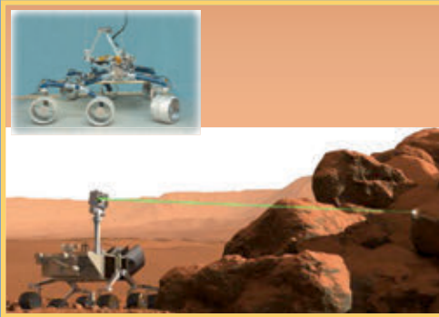
Le « Rover », petit véhicule tout-terrain capable d'analyser la composition des roches à partir de tirs LASER
