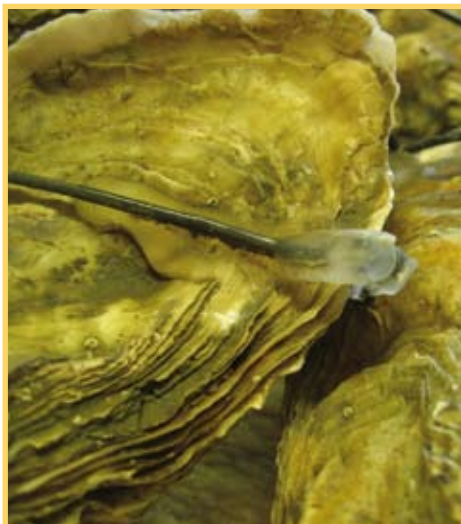
Electrode collée sur une huître, mesurant l'écartement des valves
